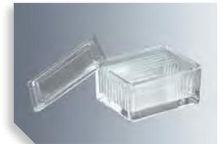
Natron-Kalk-Glas hat einen relativ hohen Ausdehnungskoeffizient. Materialbedingt dürfen die Färbartikel keinen raschen Temperaturwechseln ausgesetzt werden, sondern müssen langsam erwärmt und langsam abgekühlt werden, um Spannungsrisse zu vermeiden.
